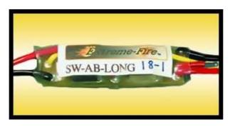
là, il en va de la survie de votre contacteur (switch assembly). Disons que les arcs d'une LiPo, en grosse partie a cause des "C" sont bien plus nocifs qu'avec des batteries Ni-MH. J'ai retrouvé, après une cinquantaines de tirs en semi auto avec une 15 C 2200 mAh, mon contacteur bouffé par éléctro-érosion!
